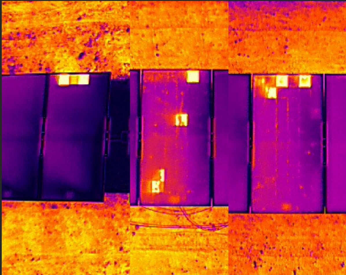
Las plantas solares pueden experimentar una **disminución en la eficiencia debido a puntos calientes, microfisuras o fallas eléctricas en los paneles**. Nuestra tecnología de drones con cámaras térmicas permite identificar y diagnosticar cada panel defectuoso sin necesidad de interrumpir la operación de la planta, ahorrando tiempo y costos de mantenimiento.
